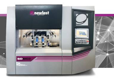
SDMC2是一个6轴工作中心,用于在鞋楦上进行特殊的钻孔和铣削周期。主轴在X、Y和Z轴上移动,而主轴则处于倾斜和旋转状态。该操作是在1对粗加工中进行的,(并最终铰接)持续,夹紧通过脚趾和脚跟支撑完成,每个循环一次在一个最后完成。这台机器装有10个工具。
