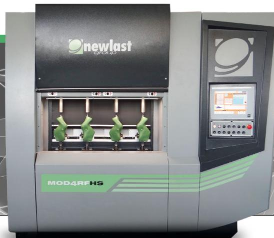
В течение одного рабочего цикла, станок выполняет операции грубой и чистовой обработки двух пар пластиковых или деревянных колодок. С MOD4RF HS можно быстро и точно выполнять файлы .FRV™ всех размеров. Вы можете выбрать различные типы программ:
