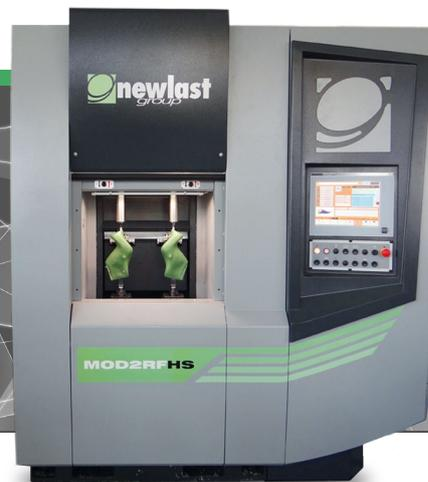
В течение одного рабочего цикла, станок выполняет операции грубой и чистовой обработки пары пластиковых или деревянных колодок. С MOD2RF HS можно быстро и точно исполнять файлы .FRV™ всех размеров. Вы можете выбрать различные типы программ:
